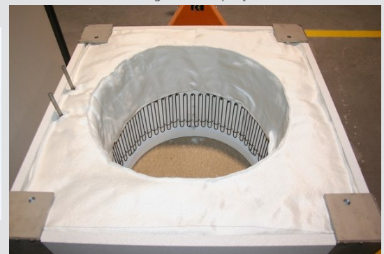
| Garnissage isolant de four avec intégration des résistances électriques
